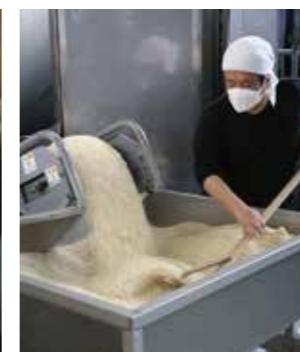
写真左上/仕込み蔵（左手の建物）と樽庫。樽庫は全部で4つあります 写真右上/蒸留機の中で焼酎ができあがる瞬間 写真左/樽の中で熟成させることにより、琥珀色をしたまろやかでコクのある焼酎に 写真右/ドラム式の製麹機により1回につき750kgの麹が安定的につくられていきます
