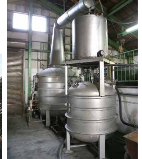
写真左上／大きなタンクが目印の焼酎蔵は、中に入ると想像以上の広さです 写真右上／寒仕込みで造られたもろみを単式蒸留機に入れ、常圧蒸留を行います 写真左・右／甕やホーロー、樽を使い分けて熟成をすることで、個性豊かな焼酎が生まれます
