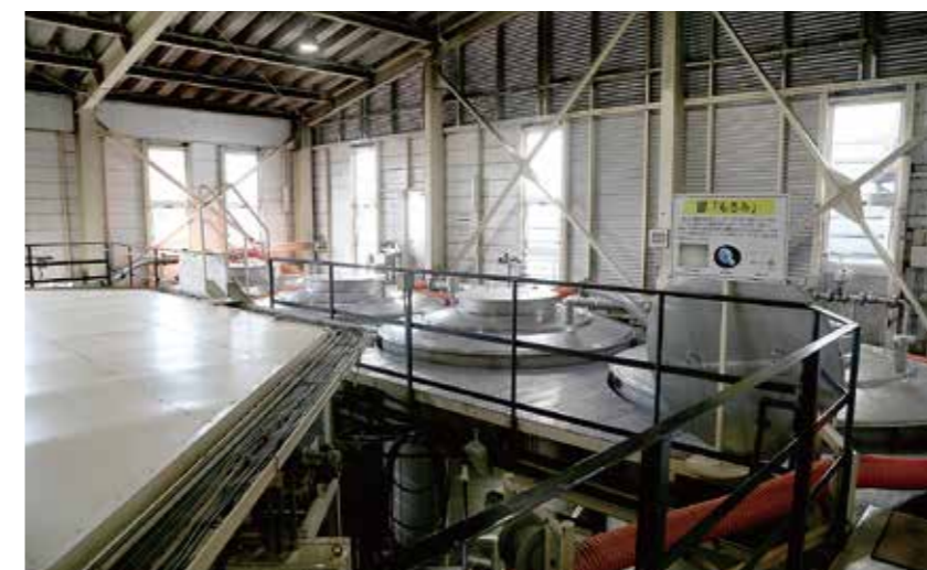
製麴和一次釀造的槽體等，工廠設備安裝齊全可應付龐大的產量。
