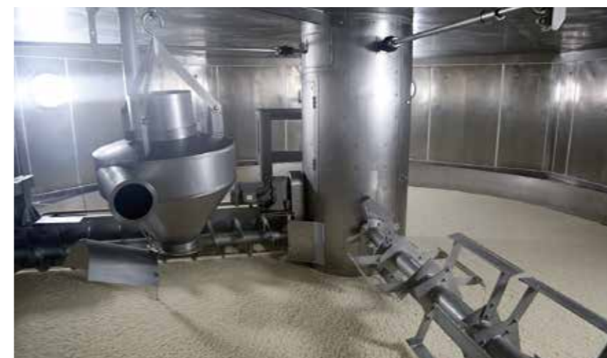
容量約 3 噸的巨型旋轉式製麴設備。大容量製麴是在溫濕度管理下進行的。隨著產量的增加，也推進機械化以維持品質。
